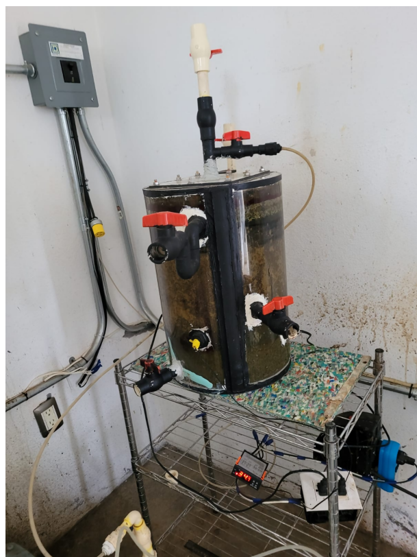
Figura 1. Reactor RAFA escala piloto usado para la generación de biogás
