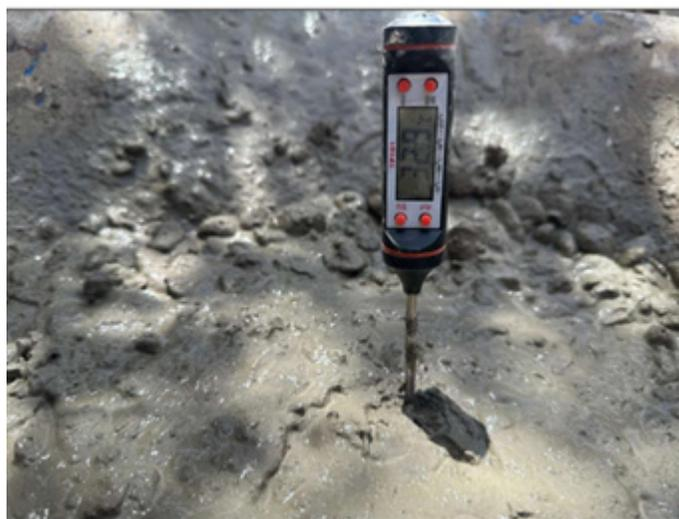
**Figura 4. Determinación de temperatura en concreto fresco[9]**
