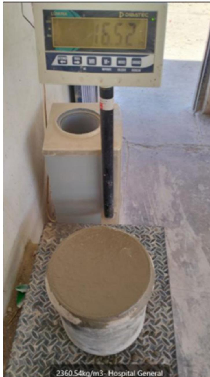
**Figura 1. Mezcla de concreto Industrial, Masa volumétrica de 2360kg/m<sup>3</sup>**
