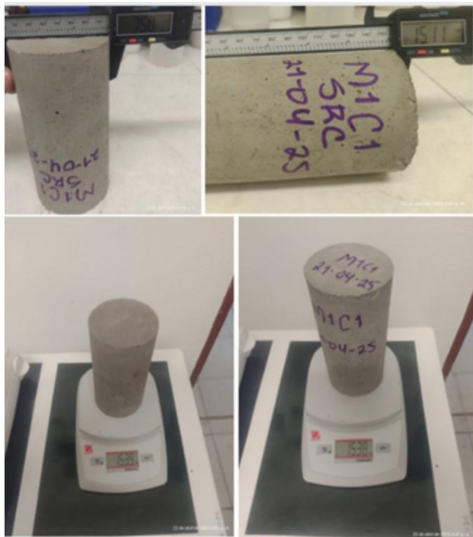
**Figura 8. Evidencia de determinación de masa unitaria de testigos en laboratorio.**
