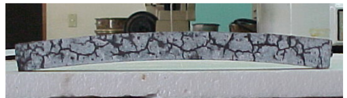
Figura 7. Deformación por pandeo a los 120 días del banco de materiales 3A.
