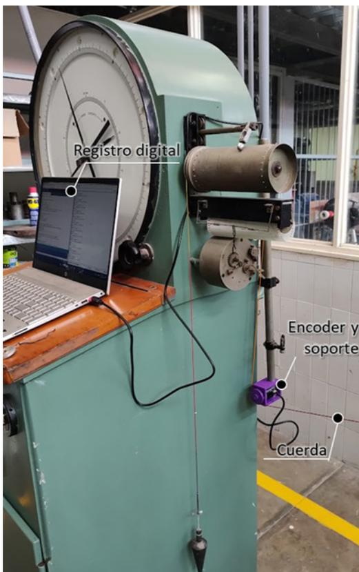
Figura 9. Instalación de encoder para registro del desplazamiento.
