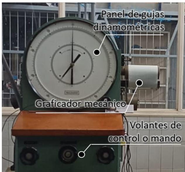
Figura 2. Elementos de la sección de mando de la maquina universal.
