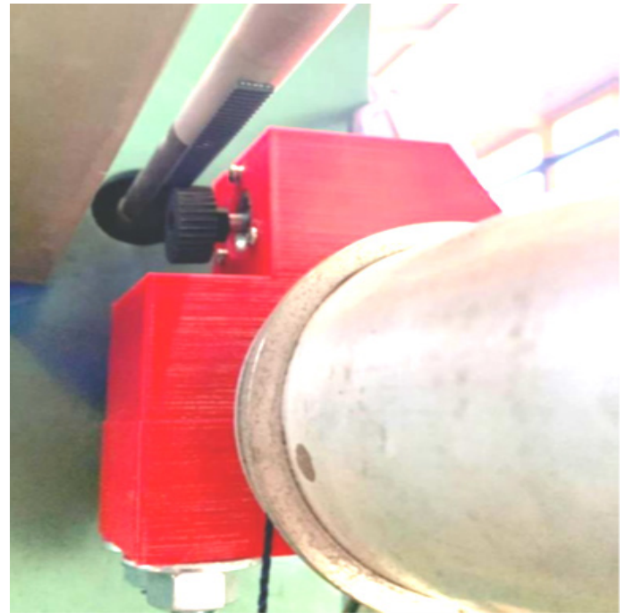
Fig. 15. Conexión varilla y encoder.
