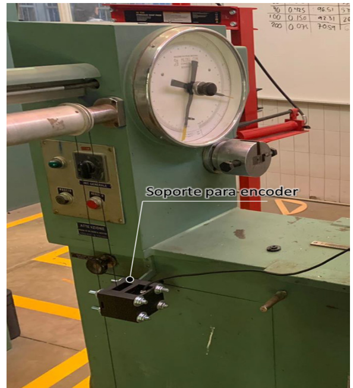
Fig. 12. Instalación de encoder para la deformación angular.
