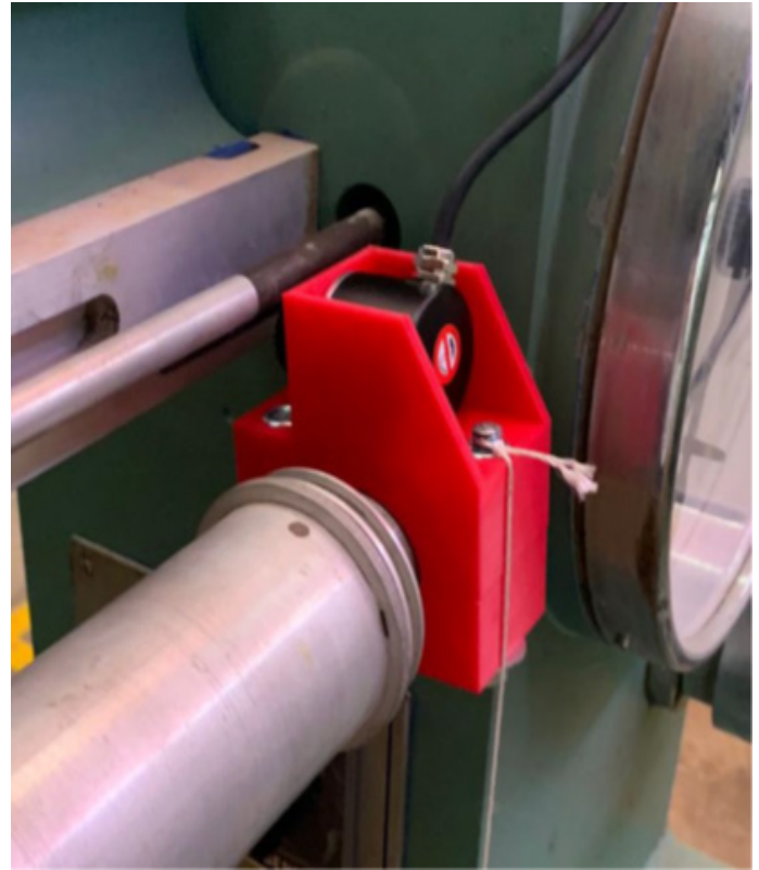
Fig. 14. Instalación del encoder para registrar el torque.
