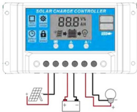
Figura 3. Conexión de un SFVA [19].
