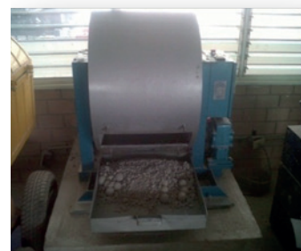
Figura 2. Preparación del material, etapa de trituración mecánica
