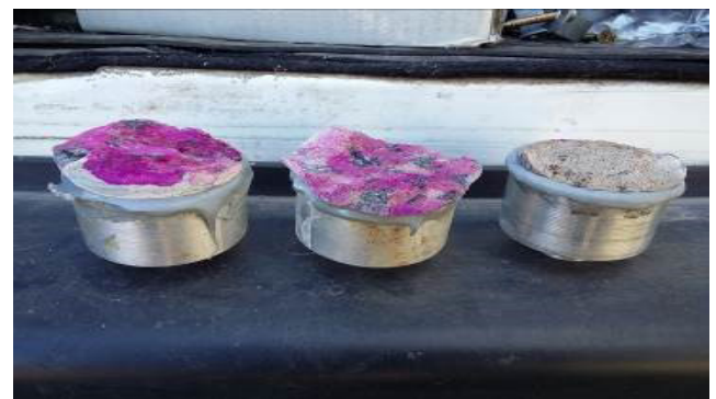
Figura 15. Extracción de dollys para ensayo de tracción. Ensayo de carbonatación
