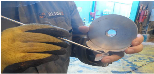
Figura 23. Preparación de muestra para determinación de ion Cl mediante RCT
