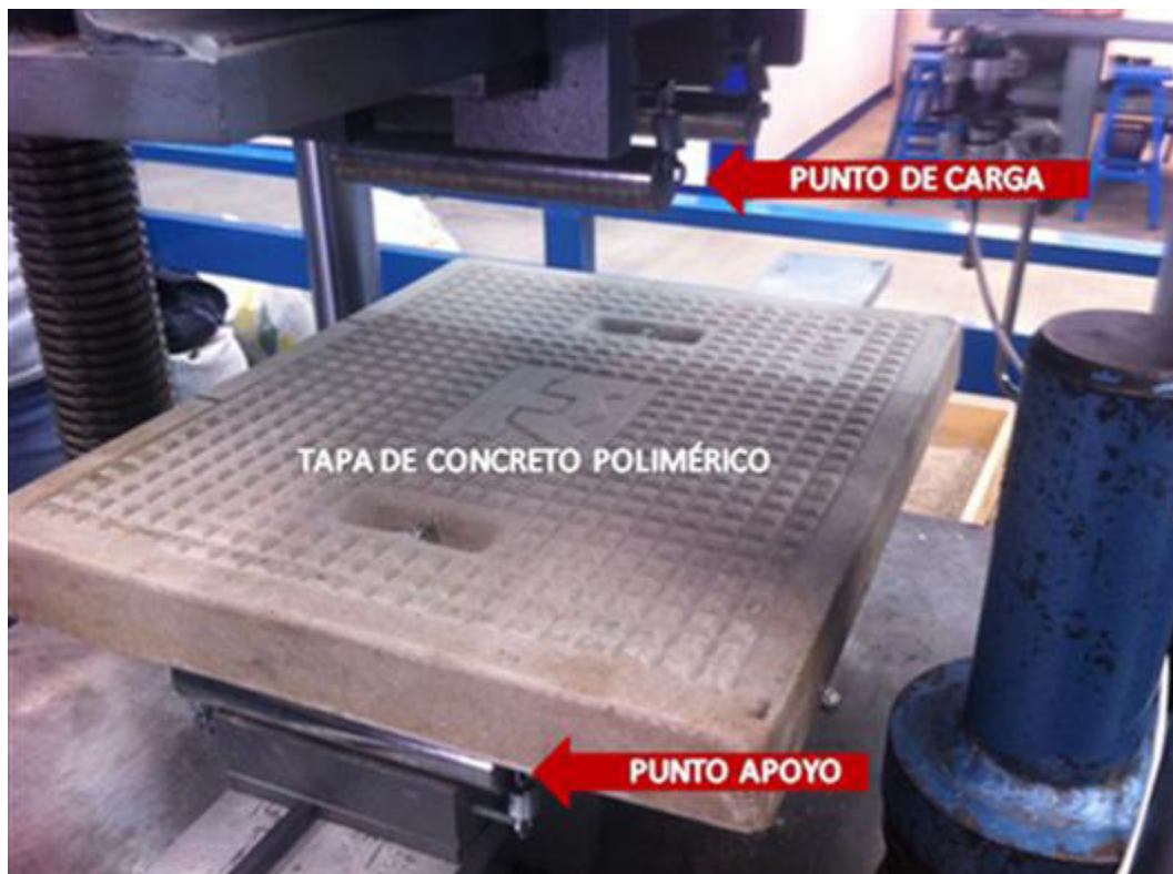
Figura 4. Tapa colocada sobre dispositivo en flexión
