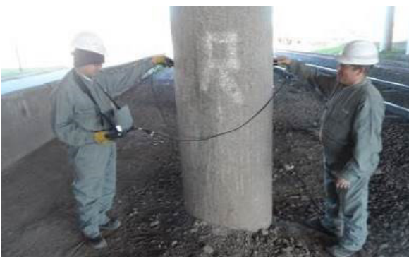
Figura 14. Determinación de la velocidad del pulso de onda (ensayo de ultrasonido)
