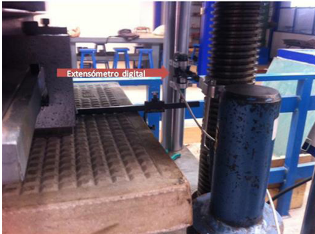
Figura 5. Dispositivo para medir la deflexión al centro del espécimen
