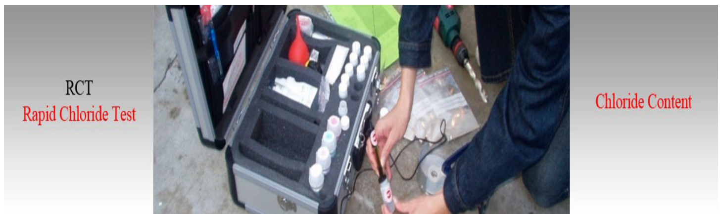
Figura 4. Determinación de la concentración del ion Cl mediante RCT
