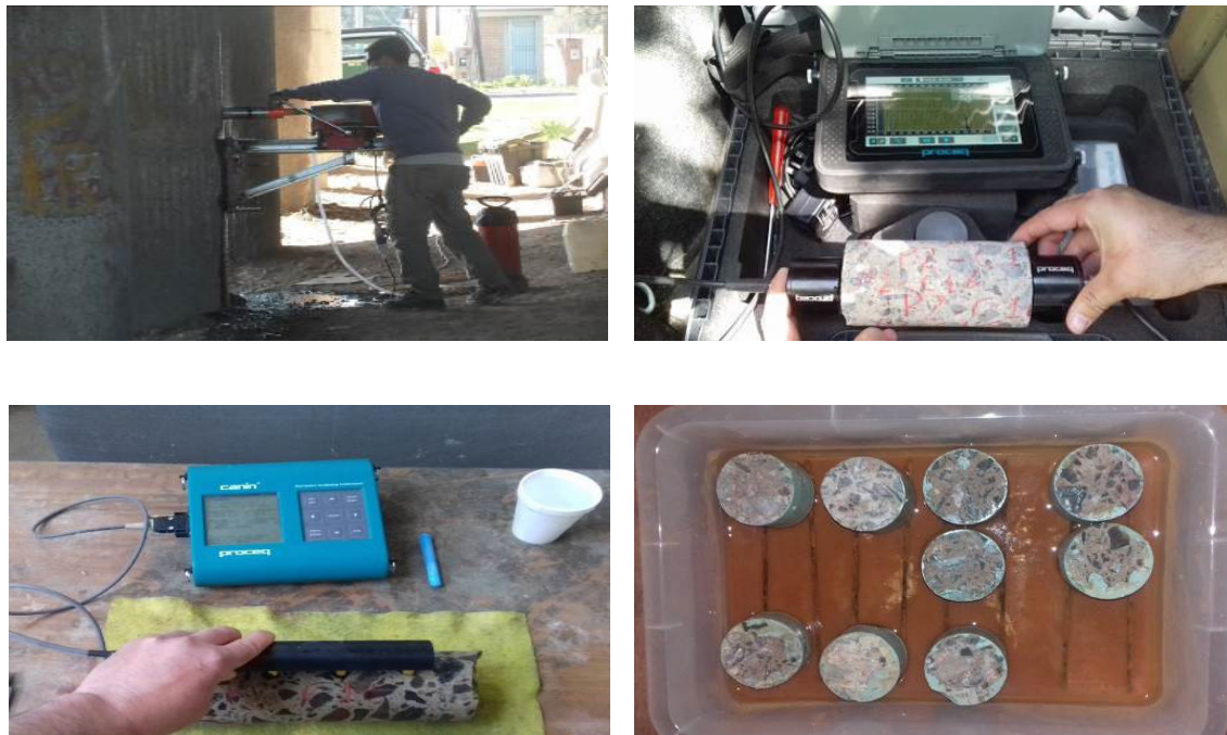
Figura 17. Ensayos en testigos de concreto extraídos
