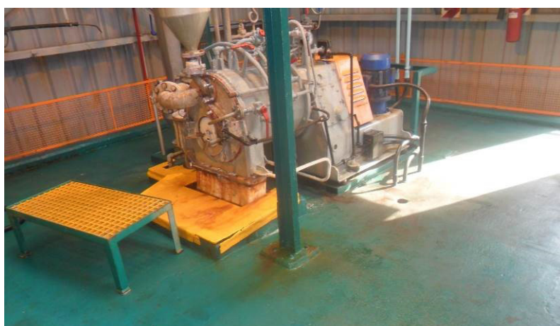
Figura 20. Losa de entepiso de concreto reforzado. Apoyo de centrifugadora
