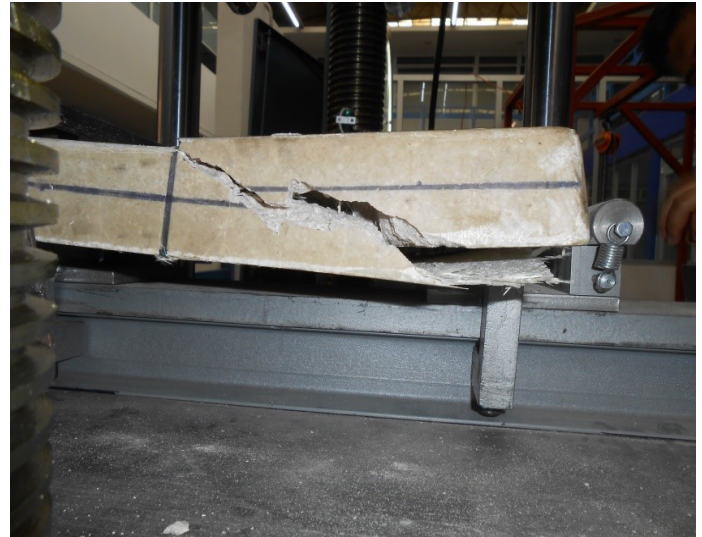
Figura 11. Desprendimiento de capa de fibra de vidrio espécimen CPFV-2
