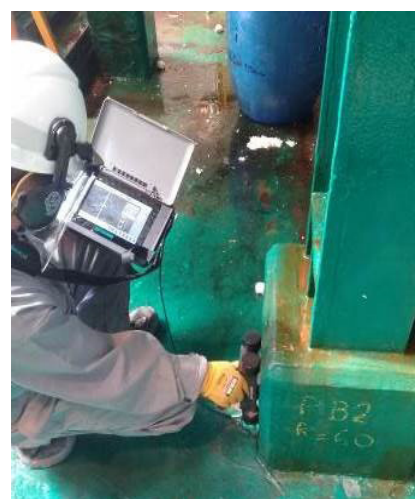
Figura 21. Detección de armadura en pedestal
