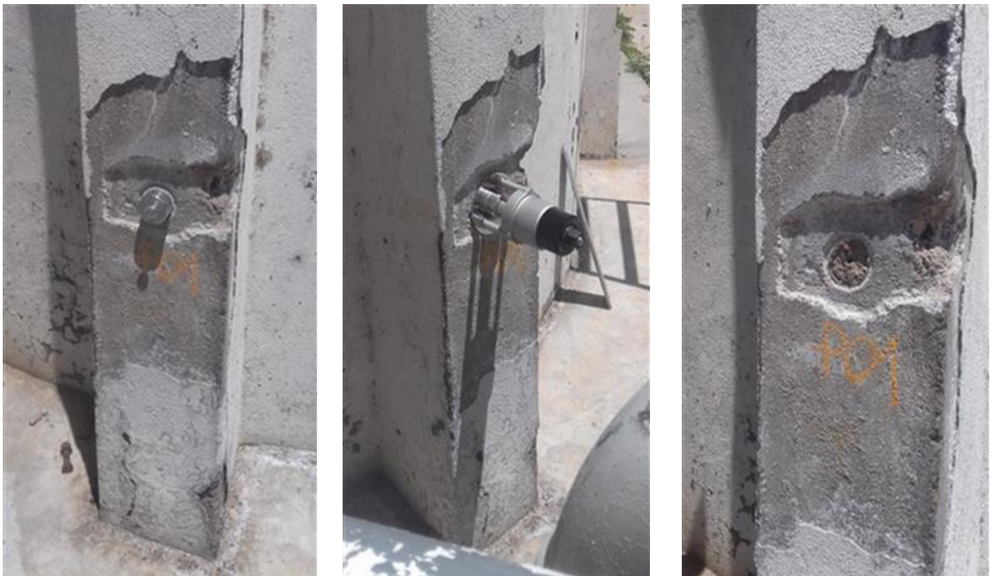
Figura 7. Ensayo de Pull-Off
