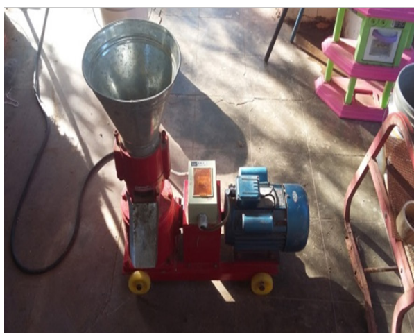
Figura 3. Picadora de forraje eléctrico utilizado para obtener rastrojo de maíz en polvo.
