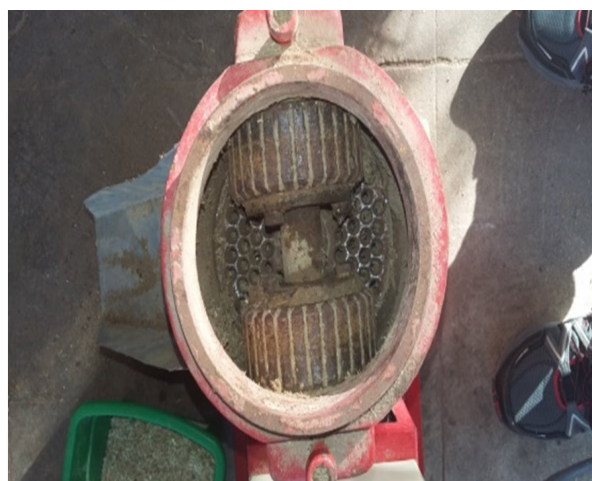
Figura 3. Picadora de forraje eléctrico utilizado para obtener rastrojo de maíz en polvo.
