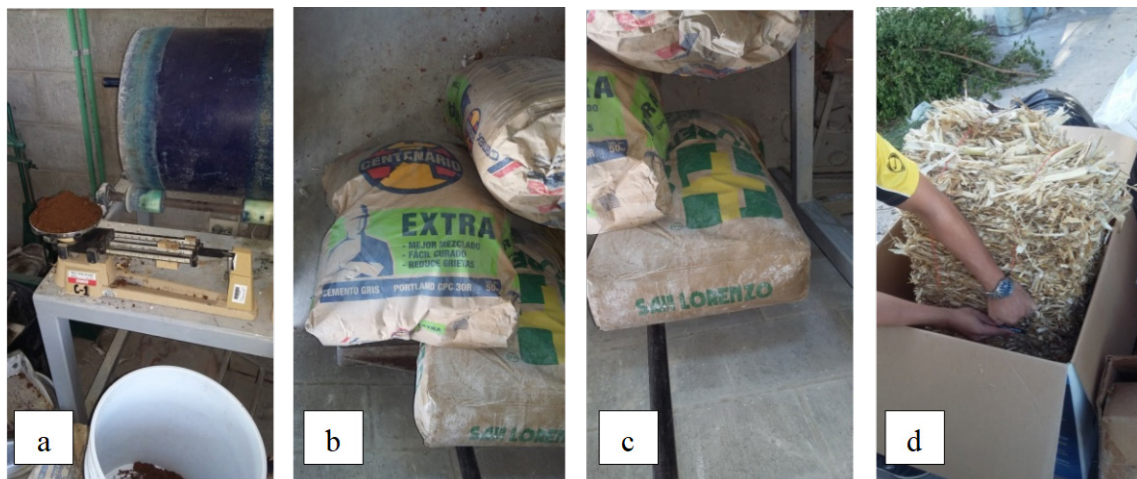
Figura 1. Materiales utilizados para generar el mortero arcilla-cal-cemento-rastrojo de maíz: a) Arcilla, b) Cemento Portland, c) Cal hidráulica y d) Paca de rastrojo de maíz.
