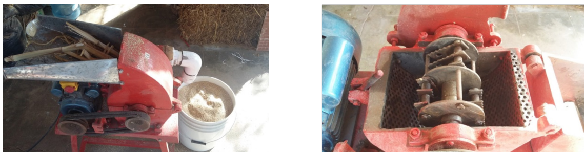
Figura 2. Picadora de forraje eléctrico utilizado para obtener rastrojo en tamaño de 3 mm.
