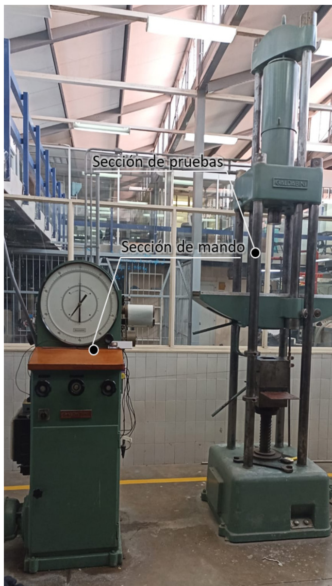
Figura 1. Sección de mando y prueba de una máquina universal hidráulica con capacidad de 50 toneladas marca italiana Galdabini.
