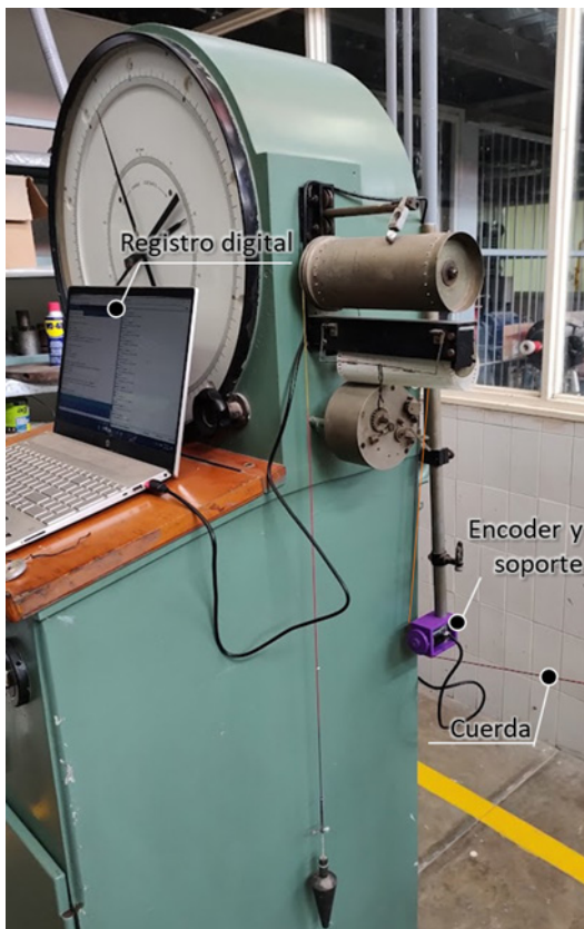
Figura 9. Instalación de encoder para registro del desplazamiento.
