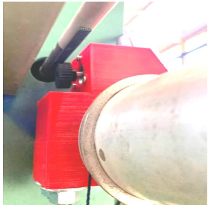
Fig. 15. Conexión varilla y encoder.
