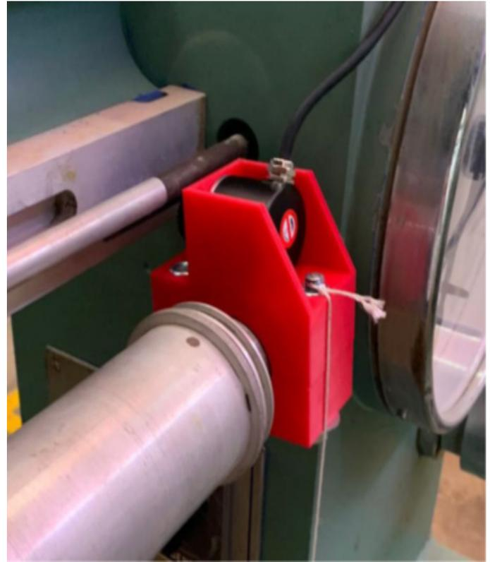
Fig. 14. Instalación del encoder para registrar el torque.
