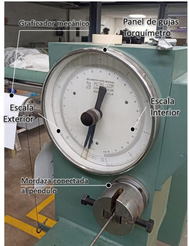
Fig. 4. Graficadora y panel de agujas de torquímetro.
