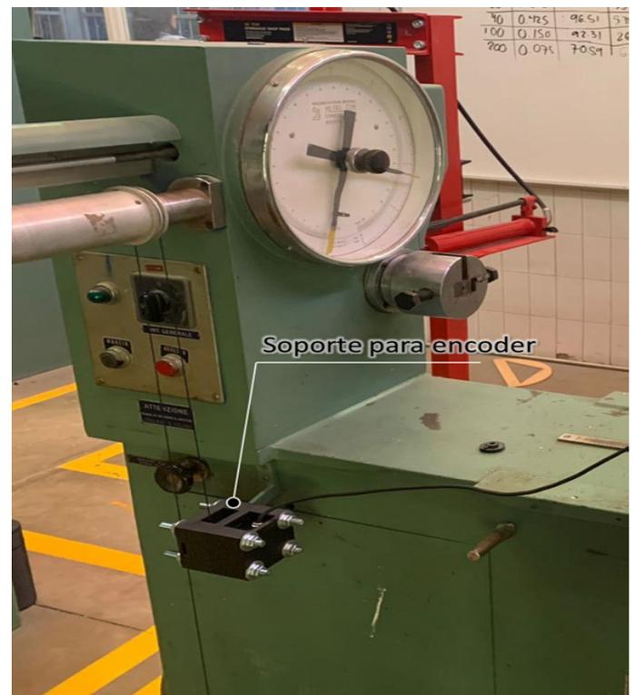
Fig. 12. Instalación de encoder para la deformación angular.
